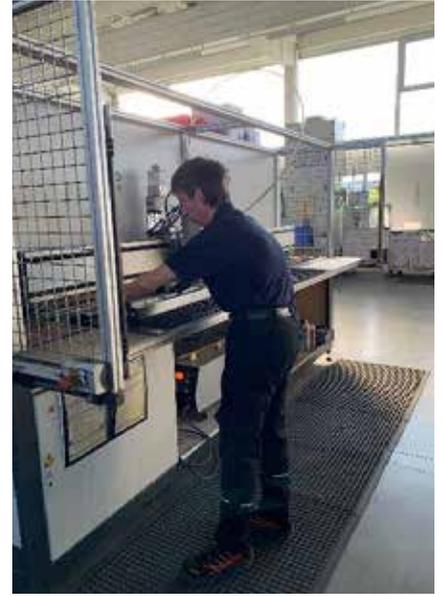
*Alexander an dem Schweißroboter beim Aufschiessen der Gewindebolzen*
